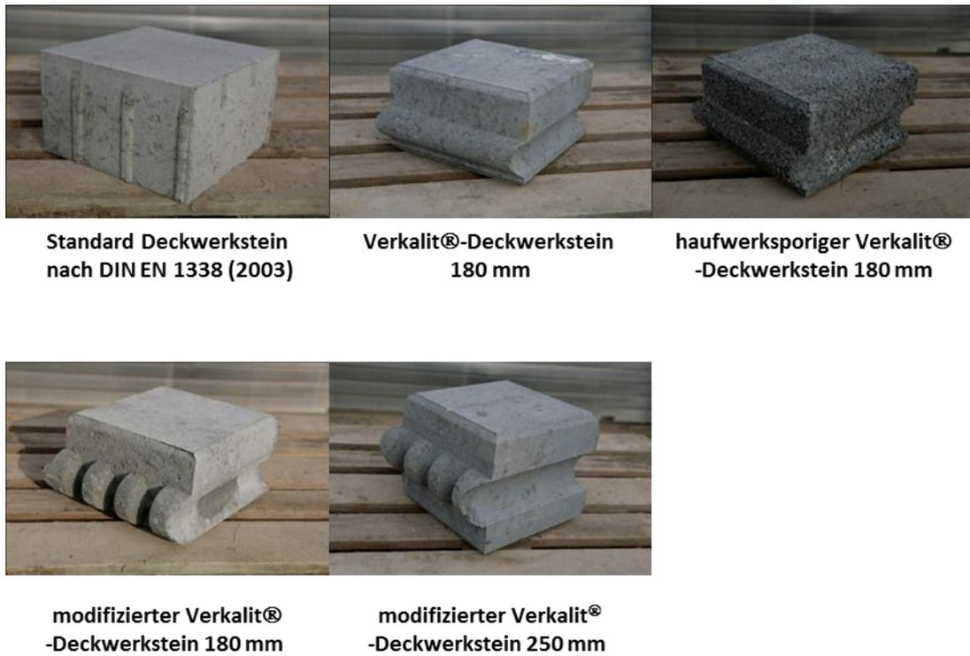
Abb. 4: Untersuchte Deckwerksteine
